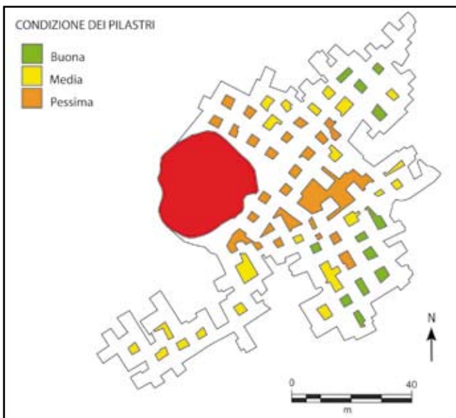
Fig. 8 - Cartografia delle condizioni dei pilastri nella cava sotterranea. Fig. 8 - Map of the conditions of pillars within the underground quarry.
