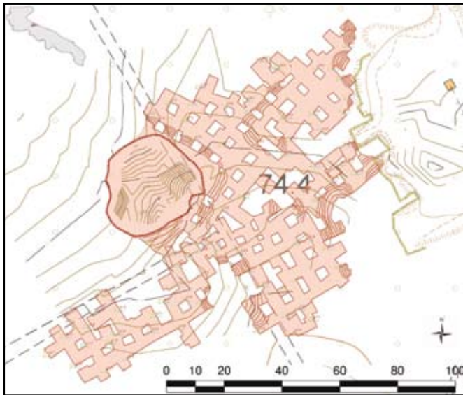
Fig. 3 - Cartografia della cava sotterranea, ottenuta dai rilievi speleologici.
